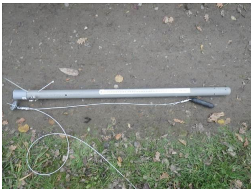
Sonde HOB0 U20, avant sa mise en place dans le puit de mesure
