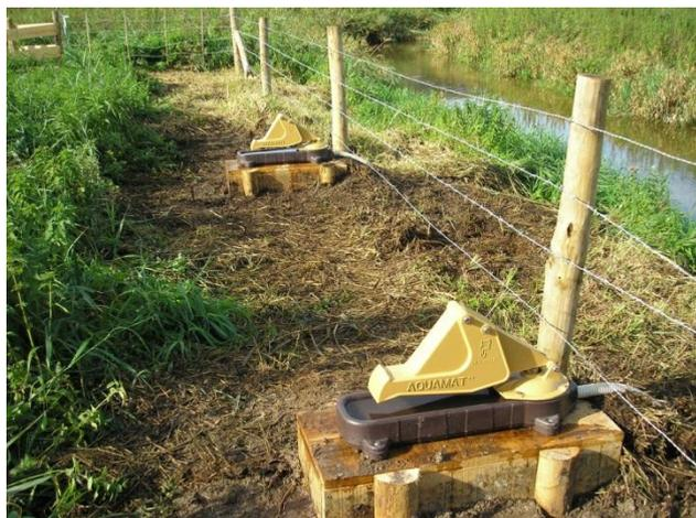
La capacité du dispositif est de 10 à 15 bovins par pompe. Ce dispositif convient à la majorité des cours d'eau, la condition d'utilisation étant une hauteur d'eau localement suffisante pour immerger la crépine sans que celle-ci ne touche le fond.
